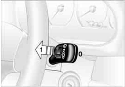
Waschflüssigkeit wird an die Frontscheibe gesprüht und die Wischer werden kurzfristig eingeschaltet.
