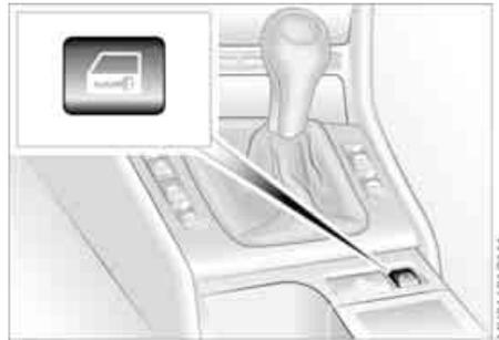
Mit dieser Taste betätigen Sie die Zentralverriegelung bei geschlossenen Vordertüren. Damit werden Türen und Heckklappe nur entriegelt oder verriegelt, nicht aber diebstahlgesichert.
