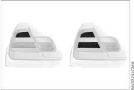
Die Zweistufigen Bremsleuchten zeigen nachfolgenden Fahrzeugen an, wie stark Sie bremsen.
