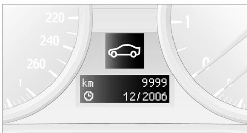
Дата очередного технического обслуживания и остаточный пробег высвечиваются на несколько секунд сразу после запуска двигателя или включения зажигания.
