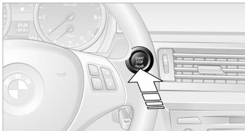
Многократно нажимая на кнопку „Старт/Стоп“, Вы сначала включаете положение „Радио“, затем зажигание, а затем выключаете их.
