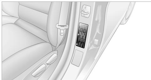
Нормы давления воздуха в шинах рекомендованных типоразмеров приведены на стойке двери. Чтобы увидеть их, откройте дверь водителя.
