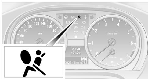
После поворота ключа зажигания в положение „Радио“, см. страницу 40, на несколько секунд загорается сигнальная лампа. Этим она сигнализирует о готовности системы НПБ и преднатяжителей ремней безопасности к работе.
