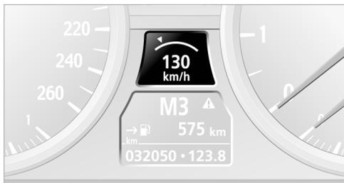
Система запоминает и в дальнейшем поддерживает текущую скорость. Значение скорости отображается на спидометре и (кратковременно) на дисплее в комбинации приборов.
