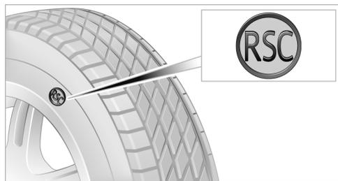
Шины Runflat можно узнать по круглому значку с надписью RSC на боковине. Колесо Runflat состоит из самонесущей шины и специального диска. Усиленные боковины позволяют, хотя и с ограничениями, продолжить движение даже на спущенной шине.
