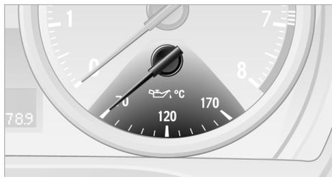
Температура масла в двигателе в норме колеблется от 70 °С до 170 °С. При слишком высокой температуре масла на дисплее управления высвечивается сообщение.
