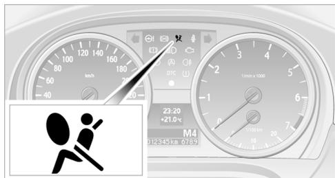
После поворота ключа зажигания в положение „Радио“, см. страницу 52, на несколько секунд загорается сигнальная лампа. Этим она сигнализирует о готовности системы НПБ и преднатяжителей ремней безопасности к работе.
