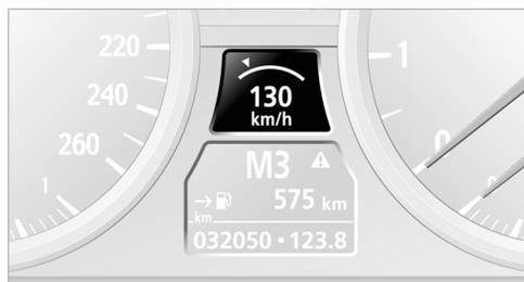
Система запоминает и в дальнейшем поддерживает текущую скорость. Значение скорости отображается на спидометре и (кратковременно) на дисплее в комбинации приборов.
