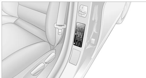
Нормы давления воздуха в шинах рекомендованных типоразмеров приведены на стойке двери. Чтобы увидеть их, откройте дверь водителя.
